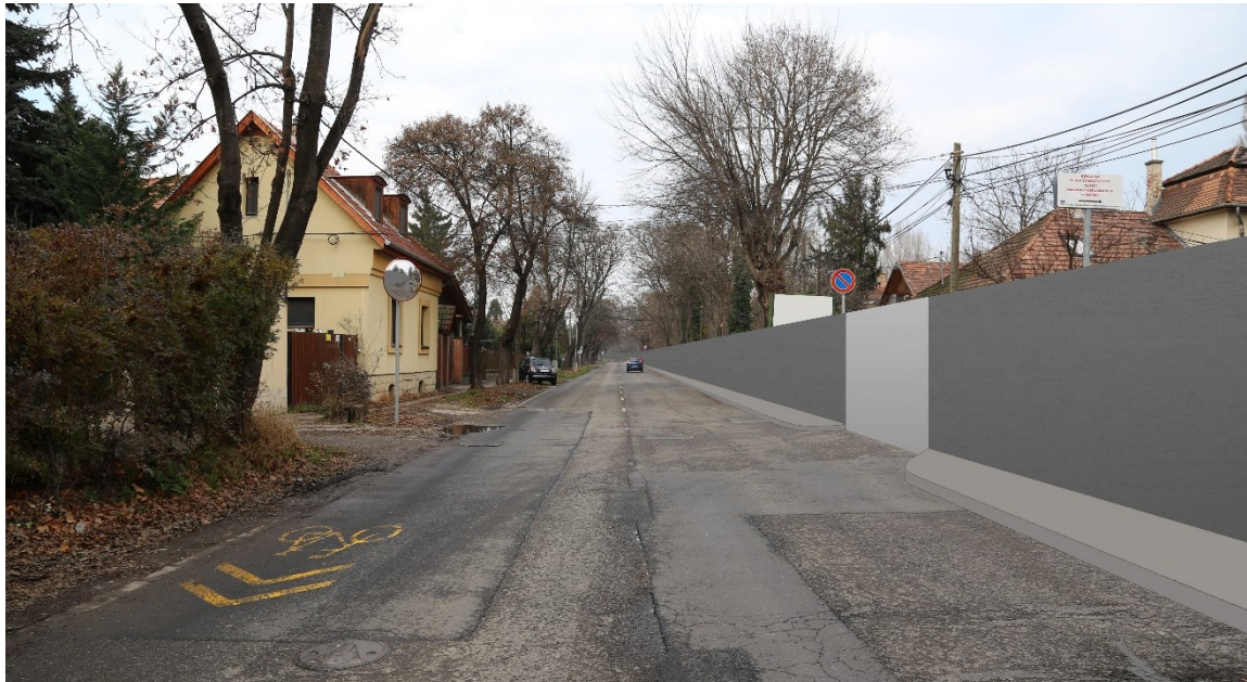
7. 5. fejezet 2. kép Beton árvízvédelmi fal a Nánási út – Királyok útján a mobil árvízvédelmi falból kialakított kulisszanyílás bezárásával
