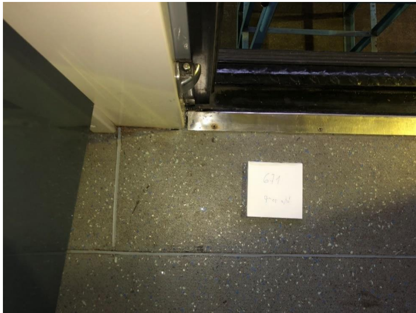
16. ábra: „P1” szerelvény padlóburkolat, padlójavítás után – forrás: BKV Adatszolgáltatás
