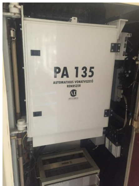
7. ábra: Korszerűsített M3 metrószerelvény AVR (PA 135) egység a vezérlő motorkocsin (Járműszemle 2020.07.24-én)
