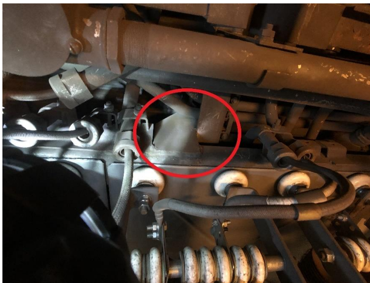
2. ábra: Segédkonzol kedvező kivitelű függesztése 293 psz. motorkocsi 2020.07.24
