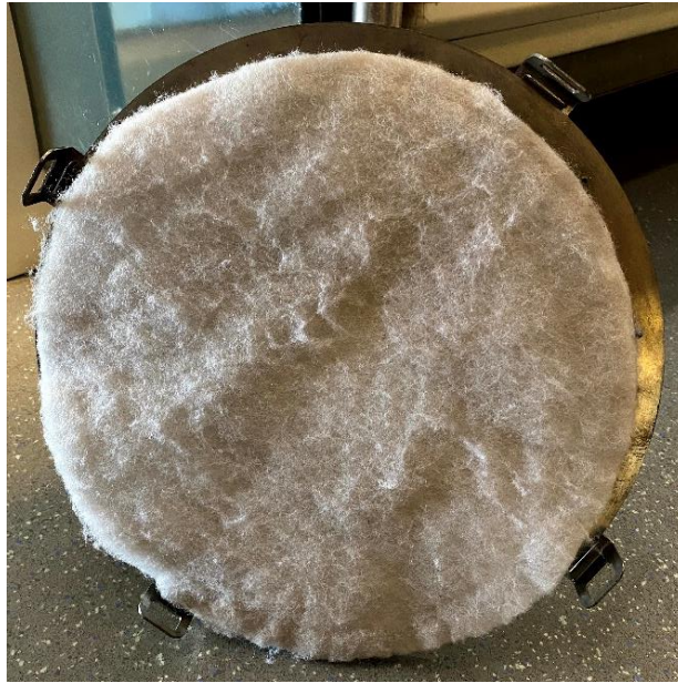
17. ábra: A kényszerszellőző berendezés szűrőbe-tétje, járműszemle 2020.07.17.
