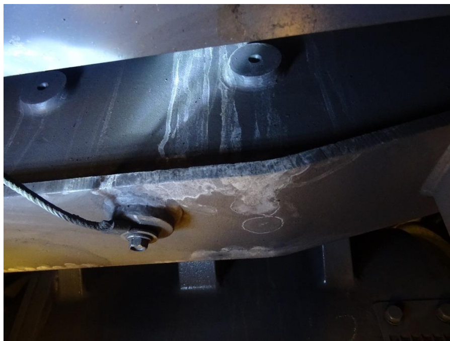
62. ábra: Korróziós károsodás sebességét fokozó klór jelenléte, folyásnyomokban rakódik le, Járműszemle 2020.07.10-én
