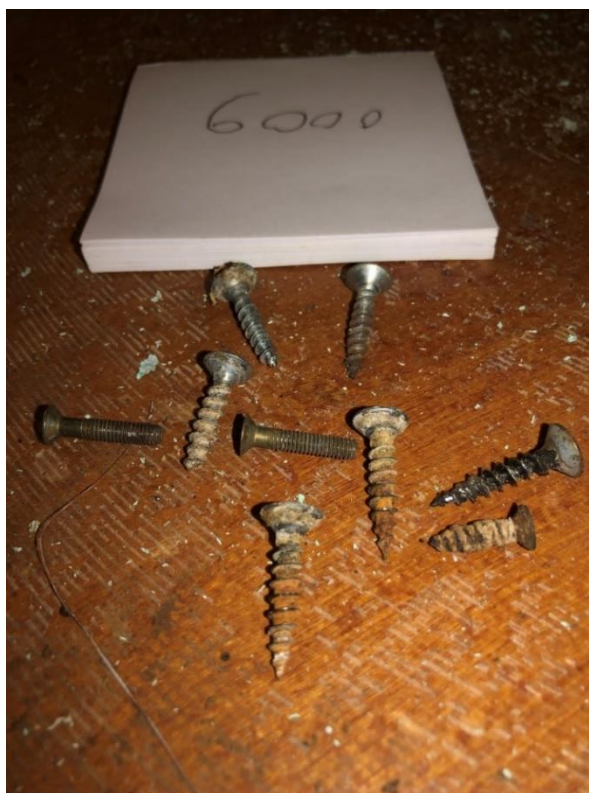
75. ábra. A 'P1' szerelvény padló bontása során összegyűjtött különféle padló rögzítésre alkalmazott kötőelemek [61]
