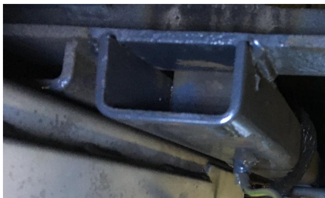
36. ábra: ábra „U” alakú tartó beépítése a 668 psz. motorkocsi alvázán 2020.07.03
