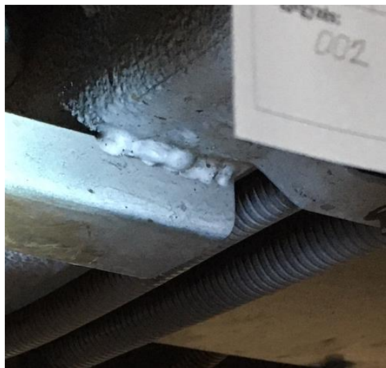
18. ábra: „P1’ szerelvény – alkalmazott segéd tartó anyaga anyag hegeszthetősége megkérdőjelezett, járműszemle 2020.07.10
