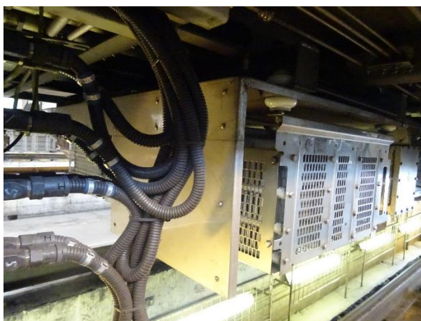
26. ábra: 668 psz. motorkocsi új, megfelelő kialakítású kábelvezetése
