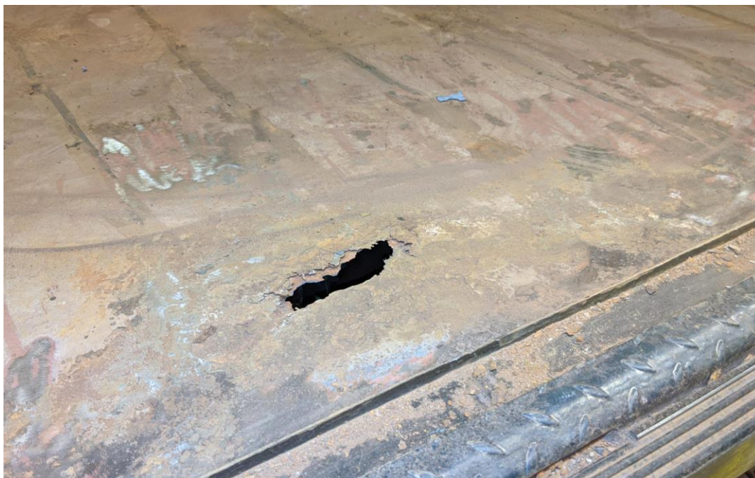
63. ábra: Erősen korrodált, átlukadt padló a P1 szerelvényben [61] (2019.12.10.)
