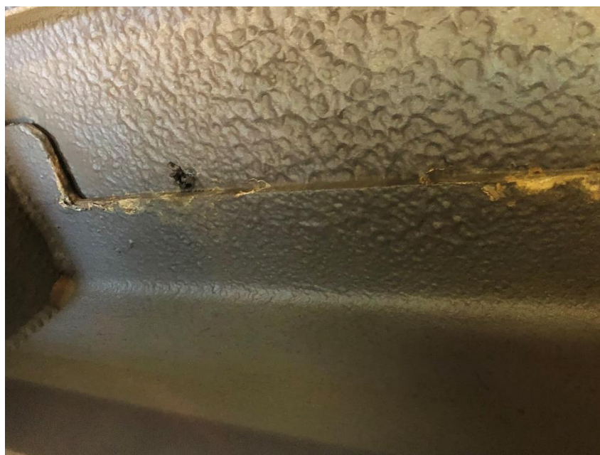
60. ábra: Korróziós károsodás sebességét fokozó klór jelenléte, folyásnyomokban rakódik le, Járműszemle 2020.07.10-én
