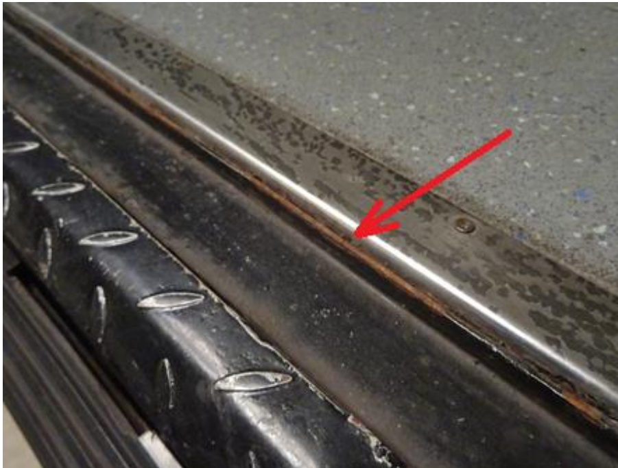
52. ábra: A víz a küszöb és a padlót lezáró L profil között is bejuthat, járműszemle 2020.07.10-én
