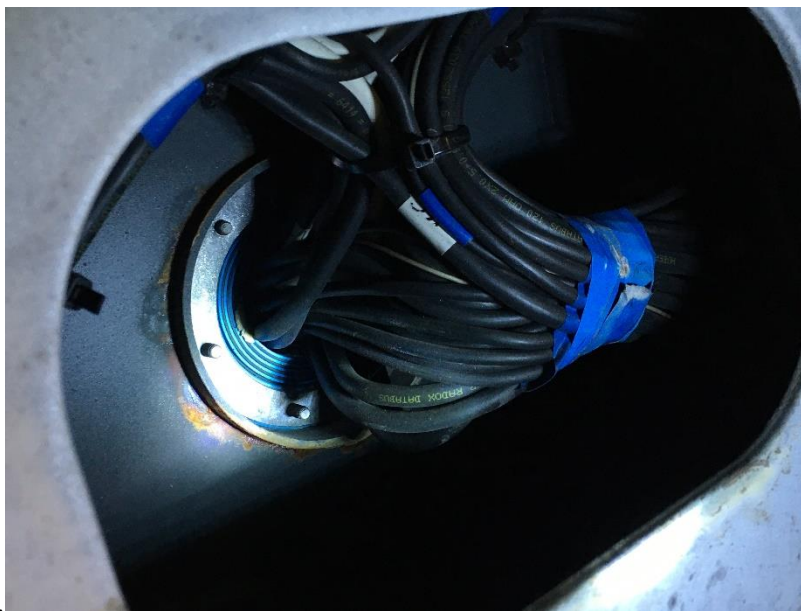
23. ábra: Kábelátvezetés az utastérben található kábelszekrénybe a kocsni alól, a 668 psz. motorkocsin
