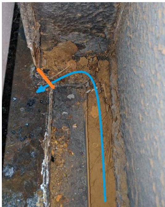
44. ábra: A P1 szerelvény padló javítása során rögzített felvétel a zsákszerkezetről, forrás [61]
