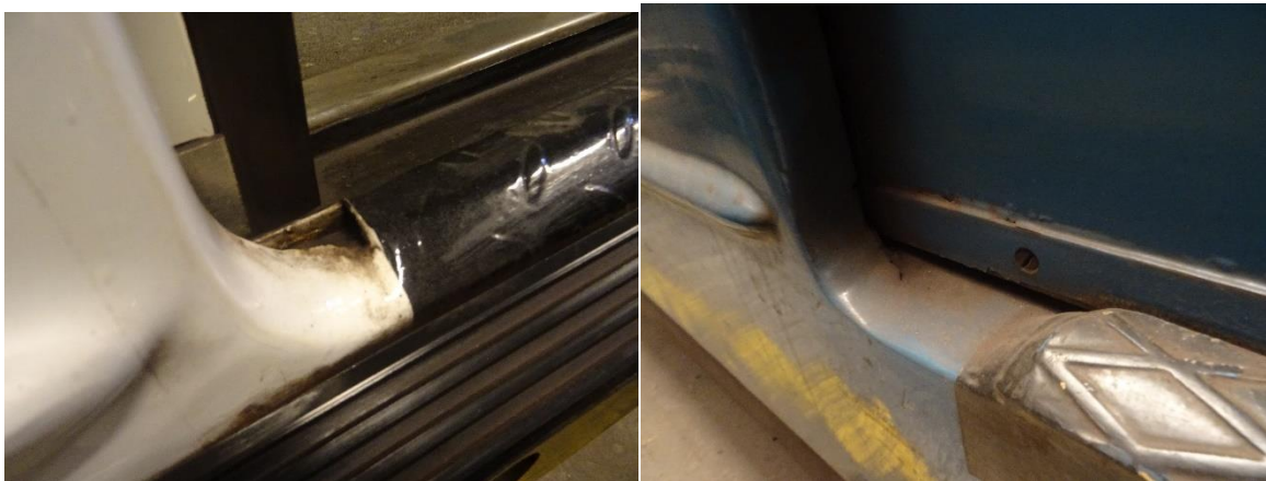
51. ábra: Az új, és a véletlenszerűen az új járműveken is előforduló régi küszöb kialakítás 2020.07.31-én
