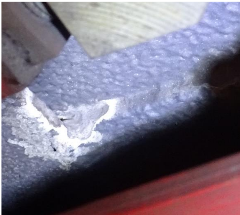
59. ábra: Korróziós károsodás sebességét fokozó klór jelenléte, folyásnyomokban rakódik le, Járműszemle 2020.07.03-án
