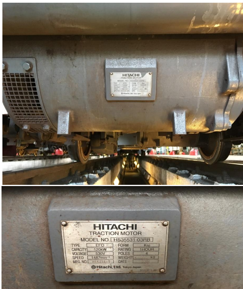
33. ábra: 864316-9 gyári számú Hitachi vontatómotor
