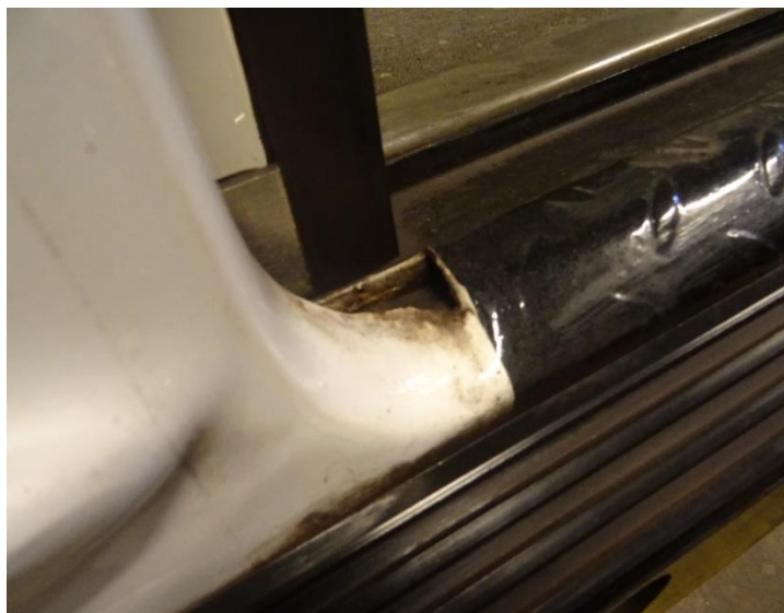
21. ábra: ,P1' szerelvény küszöb kialakítás vízkivezetés nélkül, járműszemle 2020.07.17.
