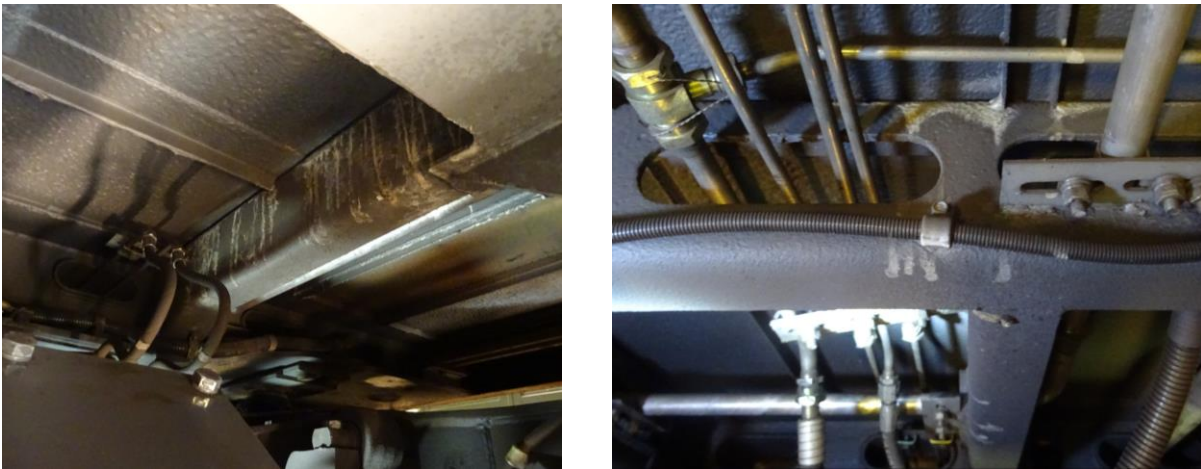
65. ábra: Klór tartalmú maradványok a padló alatt, az alváz legkülönbözőbb pontjain (2020.07.10.)
