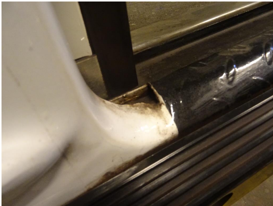
67. ábra. Új küszöb vízkivezetés nélkül (2020.07.10.)
