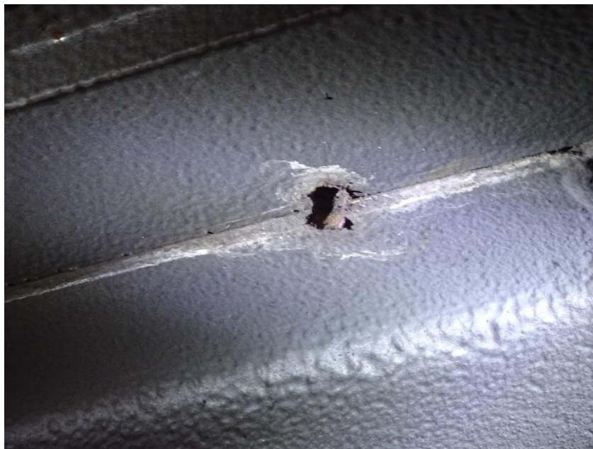
55. ábra: Vízleeresztő, de inkább „vízbevezető” funkcióval bíró furat, járműszemle 2020.07.10-én
