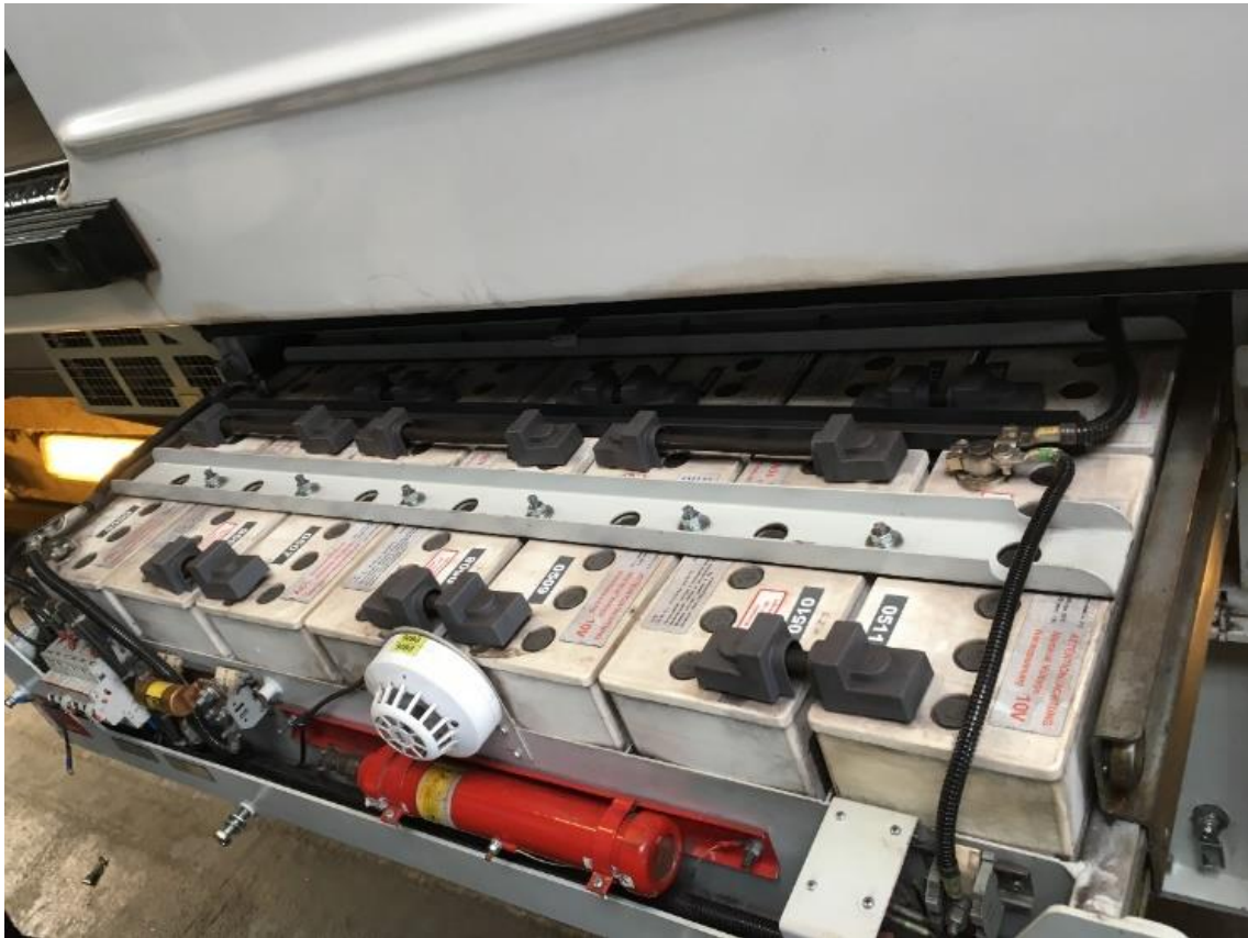
35. ábra: „BURAN” típusú oltópatron az akkumulátor rekeszben
