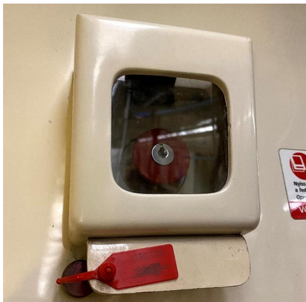
13. ábra: A vezetőfülke ajtajának reteszelésének oldását kérő gomb (Járműszemle 2020.07.24-én)
