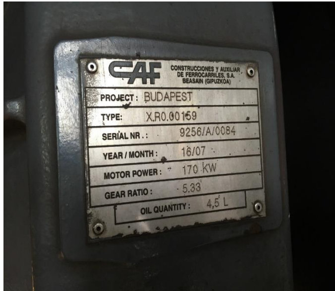
34. ábra: 9256/A/0084 számú CAF gyártmányú tengelyhajtómű
