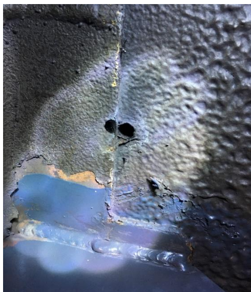
22. ábra: Reflektorfényben a felület-védelem, a hegesztés és az esőelvezető furat járműszemle 2020.07.17.
