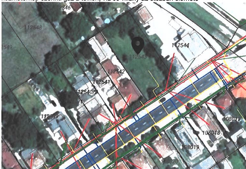
Jelmagyarázat: sárga vonal – gáz, piros vonal – villany, kék vonal – víz (a közműtérképen a csatorna vezeték nincs feltüntetve)
